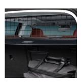
Esta rejilla de separación divide el habitáculo de los pasajeros del compartimento del equipaje desde los reposacabezas de los asientos traseros hasta el techo. La robusta rejilla de acero con recubrimiento en polvo negro puede sujetarse de forma fácil y cómoda detrás del reposacabezas de los asientos posteriores. El montaje es sencillo y no es necesario realizar agujeros. La cubierta del maletero también se puede utilizar con la rejilla divisoria.
